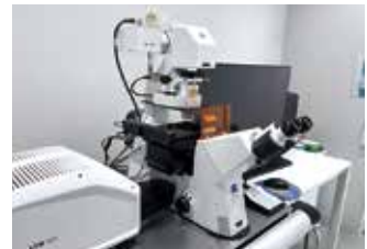
最新の共焦点レーザー顕微鏡[LSM-900 Airyscan2]。様々な蛍光標識色素に対応し、従来よりも高感度な観察が可能になりました。Airyscan2とデコンボリューションによる超解像イメージングを実現します。
