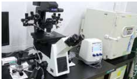
発生工芸室の遺伝子改変マウス作製機器。マイクロインジェクター、倒立顕微鏡、3次元ジョイスティック、フェムトジェットなどから構成されている。
