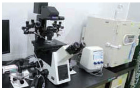
発生工学室の遺伝子改変マウス作製機器。マイクロインジェクター、倒立顕微鏡、3次元ジョイスティック、フェムトジェットなどから構成されている。
