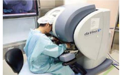
操作ボックス(コンソール)でロボットアームを遠隔操作。
