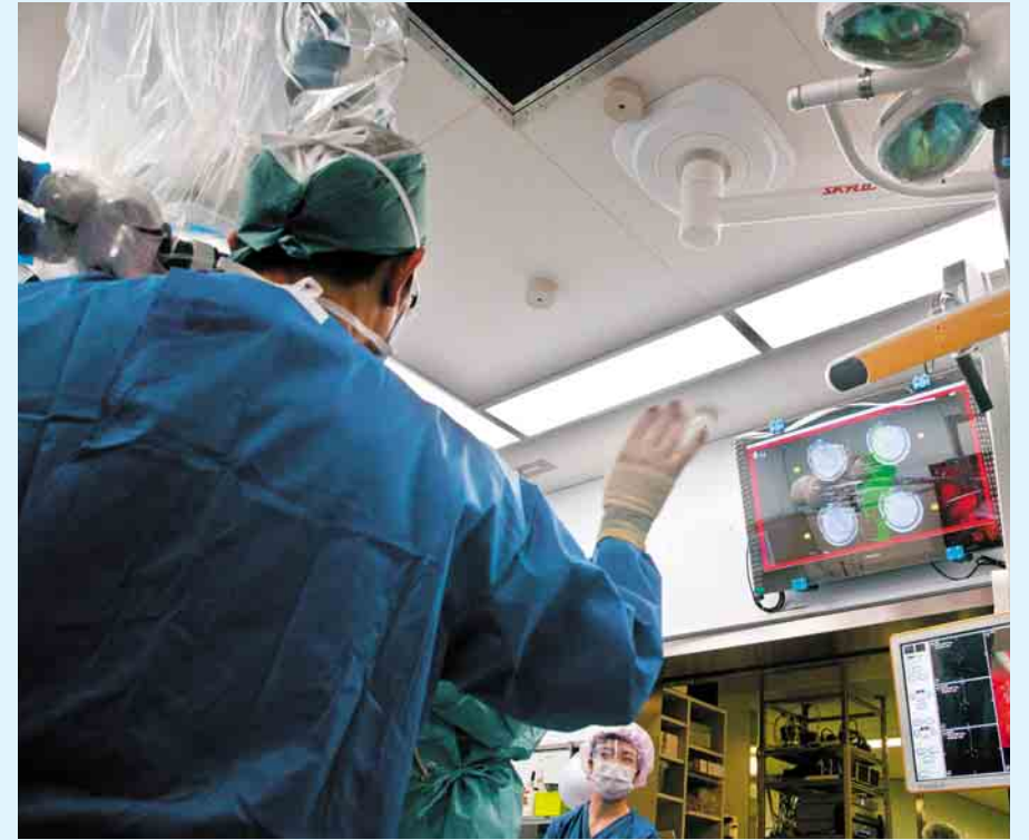
手の上下左右の動きだけでモニター画像の切り替えが可能な「Opect」を操作する執刀医。画像確認の手間が省け、手術の効率化を実現。
