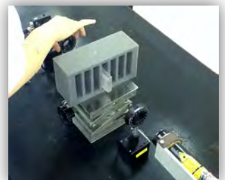
偏光したレーザーを 利用した糖度測定
